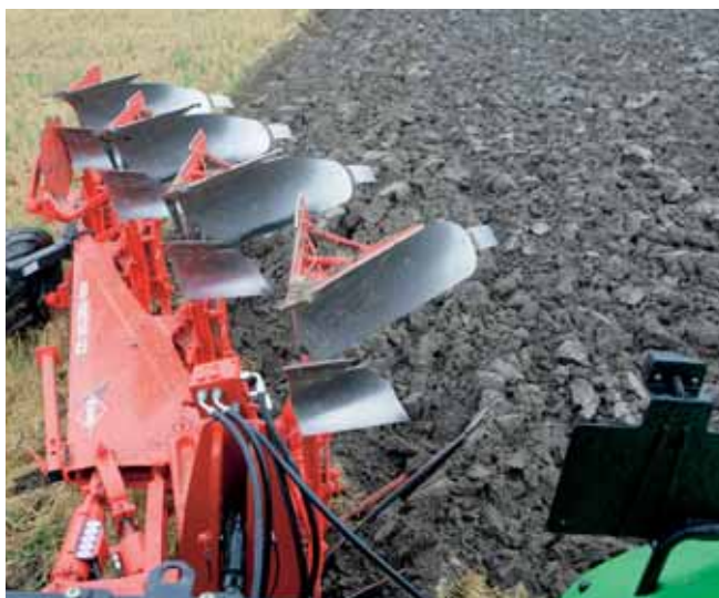
Een ploeg met hydraulisch variabele breedte-instelling is handig bij het rechtekken van een bocht of een lichte geer. Wel zijn ze enkele duizenden euro's duurder dan een gewone ploeg.
