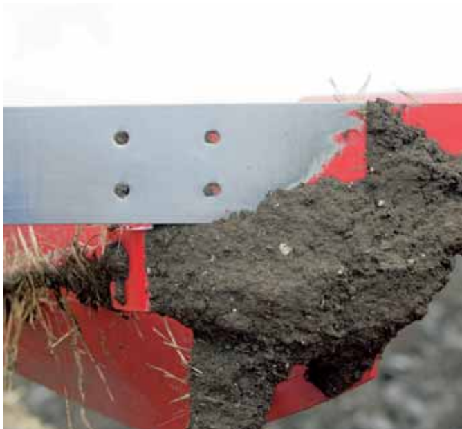
Ophoping van klei achter de tipscouters van de Pöttinger. Ook andere merken hadden soms moeite met de polderklei.
