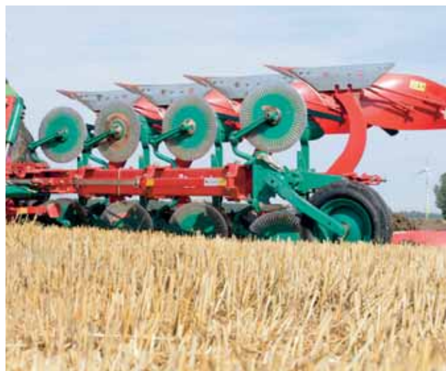
Boerderij testte ploegen met tipkouters en schijfkouters op de laatste schaar. De Kverneland heeft rondom schijfkouters, omdat het niet lukte vlak voor de test een ploeg met tipkouters te huren.
