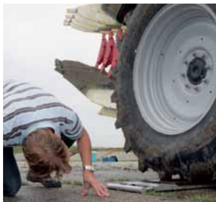
Door de trekker met ploeg op weegplaten te rijden, zijn de belasting van de achteras en de ontlasting van de vooras bepaald.
